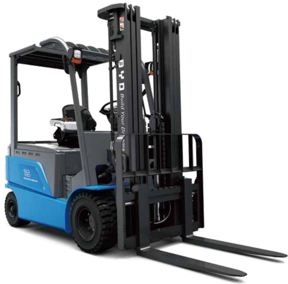
Komfortausstattung: Vollgefederter Sitz, Minihebel Steuerung, Triplex-Mast mit Dual-Freihubzylindern, 4-Wege-Ventil.
